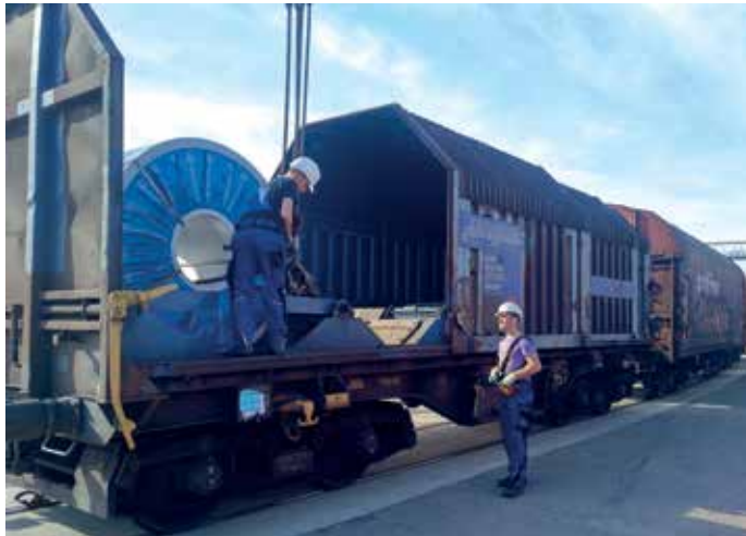
Beladung eines Zuges mit Stahlcoils | Bilder: Westfracht
