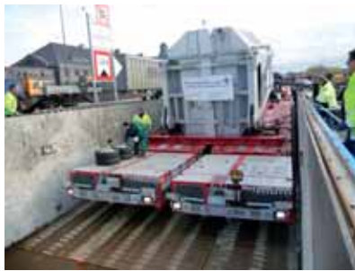
„Roll off“ mit 420 Tonnen und 13 % Steigung in Berlin
