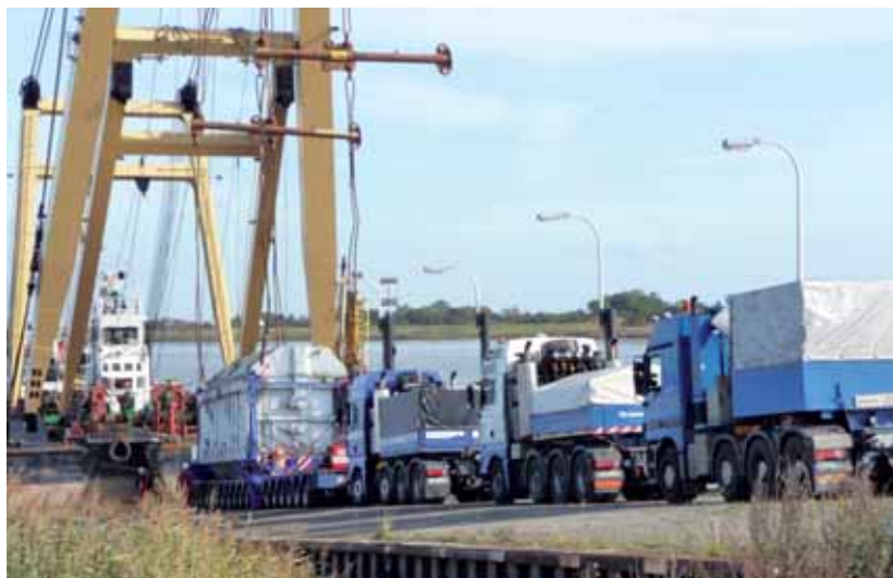
Umschlag des zweiten 420-Tonnen Alttrafos vom 21-Achs-Plateauwagen mit Schwimmkran
