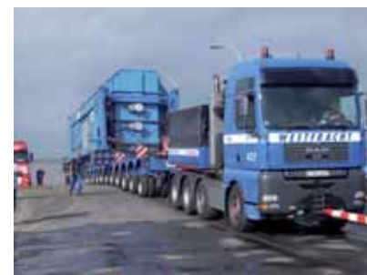
Überwindung der acht-prozentigen Steigung an der Verladerrampe
