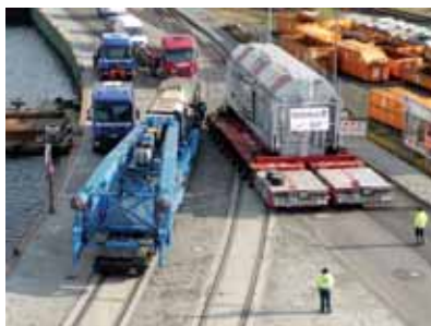
Umfuhr vom RoRo-Anleger zur Umladestelle für weiterführenden Waggontransport (32-Achs-Tragschnabelwagen)
